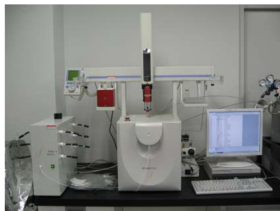
写真-1 におい識別装置FF-2A
